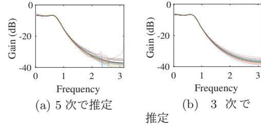
図5:  $P_u(z)$  のゲイン線図 (提案法2)
