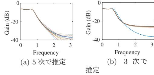
図3:  $P_u(z)$  のゲイン線図 (PBSID)
