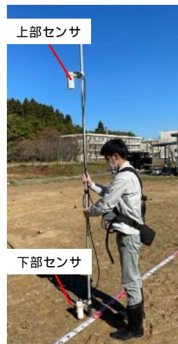
図7 光ポンピング式磁力計による磁場計測
