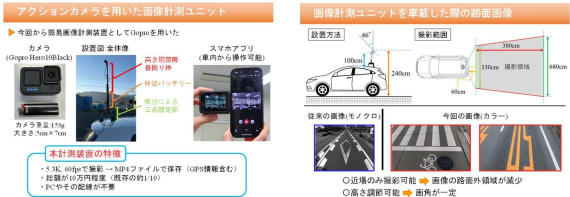
図-1 アクションカメラを用いた路面の画像計測ユニット
