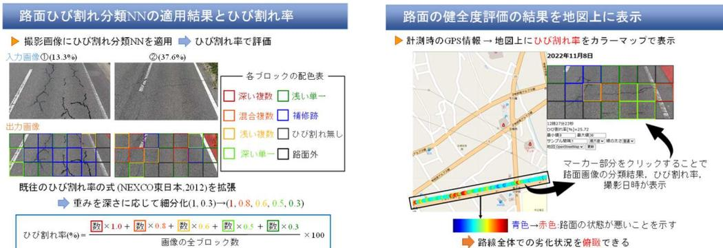
図-3 アスファルト路面のブロック分類から算出するひび割れ率とその地図上への表示
