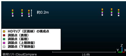
図-13 提案手法を用いて生成した各層の調製点とHDマップの区画線の構成点
