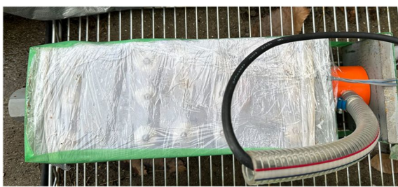
図 1 ポストテンション PC 部材 （端部のオレンジ色のものがロードセル）
