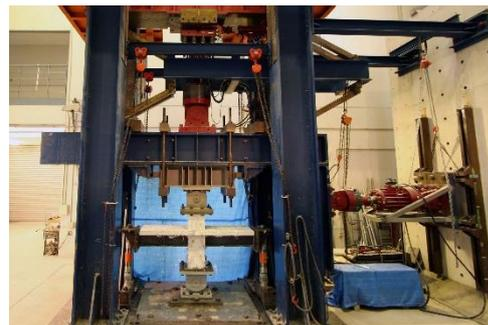
図 6 柱梁接合部の構造実験
