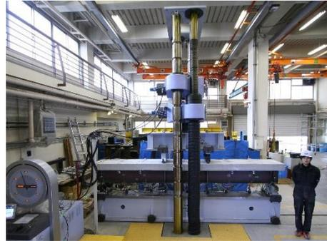
図 4 合成梁の構造実験
