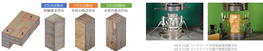
(a) 実験変数: LVL 繊維方向, 角柱と円柱 (b) 国内で初めてコンクリートと同一方法で試験実施
