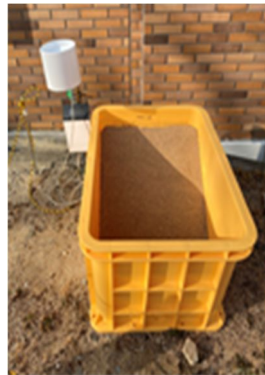
図-3 長期耐水性試験のための小型模型土槽の概要
