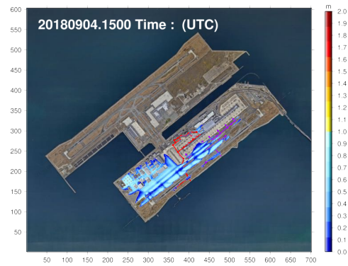
(b) 排水管の逆流による最大浸水深
