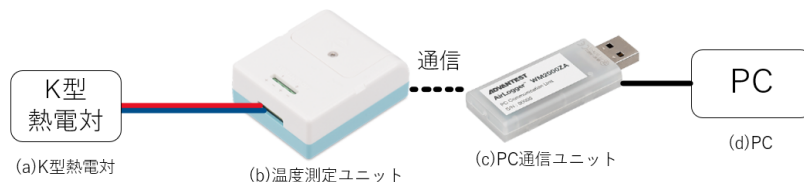
図 3 使用した温度測定システム（アドバンテスト：無線データロガー WM2000 シリーズ）
