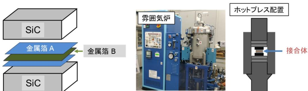
図3 SiC接合体の構成とホットプレス処理に用いた電気炉
