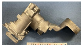
図B 350tonダイカストマシン（富山大学所有）で鑄造した鑄物部品外観
