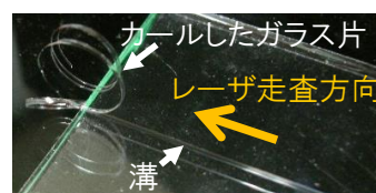
図1 板ガラスに発生した溝
