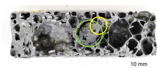
図 5 赤外線イメージ炉を使って発泡補修した試験片の断面観察写真(緑円: 補修孔, 黄円: 光学顕微鏡観察部(図 5))
