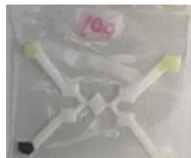
図6 4種類のアミノ酸濃度が同時計測可能なμPAD リジンを滴下した場合は左下のリジン検出部のみが呈色
