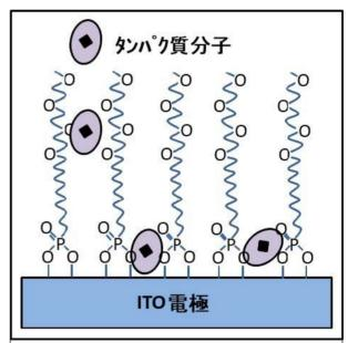
図1 ITO電極上に形成したホスホン酸自己組織 化単分子膜でタンパク質を固定化した様子
