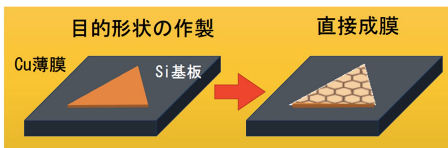
図 3 パターニング銅薄膜を用いたグラフェン成膜の概念図
