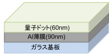
図 2 InP/ZnS 量子ドット発光特性評価試料の模式図
