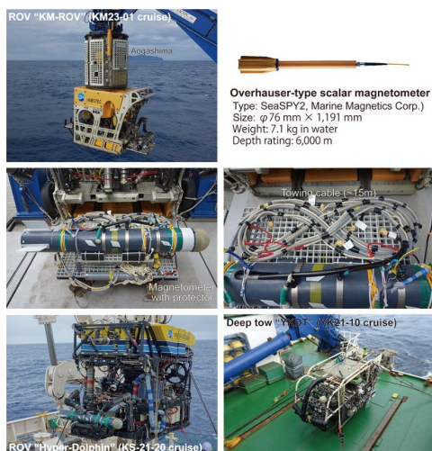
図 1 高分解能磁気探査システムの搭載
