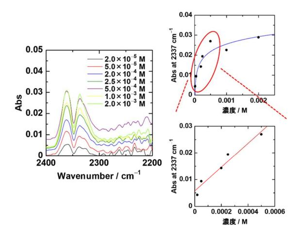
2337cm<sup>-1</sup> 付近の吸収ピーク強度を二酸化炭素濃度に対してプロットした結果 (図右上)、1 mmol/L 以上の濃度では検量線の直線性が得られないことが分かったが、 $5\times10^{-4}$  mol/L 以下の濃度では高い直線性を示す検量線が得られることが分かった(右下図)。この測定から得られた検出限界 ( $3\sigma$ ) は  $9.7\times10^{-5}$  mol/L であった。検量線の傾きから見積もられる測定感度は、44 abs・L/mol (濃度 1 mol/L のときに 44 Abs) であった。
