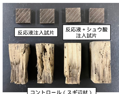
写真1 土中埋設試験1年後の試片外観
