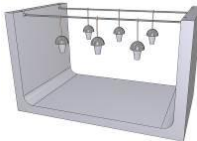
図2 物干し竿式着脱基質吊り下げ施設
