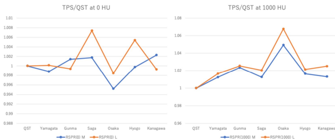
図2 各施設の治療計画（TPS）でCT値0HUに適用する阻止能比と1000HUに適用する阻止能比をそれぞれQST病院の校正機器及び校正方法で推定される阻止能比で除した比。青線と赤線はそれぞれ頭頸部用と骨盤部用の変換関係。
