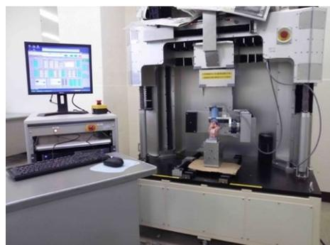
図1：関節力学試験用ロボット
