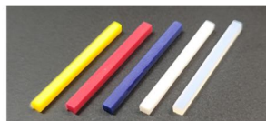
図1 基準色の曲げ試験片 左からY(イエロー), M(マゼンタ), C(シアン), W(白), CL(無色)
