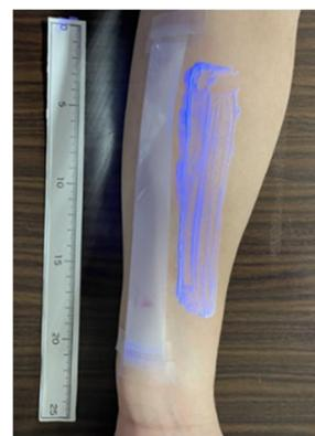
清拭圧は圧力測定フィルムをスキャンし、専用の分析ソフトを用いて圧力値を算出した。拭き取り効果は撮影した画像を2名の研究者で確認し、蛍光ローションの拭き残し量と状態を確認した。またImage-J(NIH)を用いて蛍光ローションの面積を算出し、清拭前後の蛍光ローションの拭き取り率を求めた。清拭前後の皮膚バリア機能を確認するためにTEWLと皮膚水分量を測定した。清拭圧の測定には圧力測定フィルム(プレスケール®:富士フィルム社製)超微圧用(5LW, 6.0~50.0kPaまでの測定が可能)を用いた。シートはツーシートタイプで、発色剤と顕色剤が別々の支持体に塗布されたフィルムとなっており、薬品塗布面を重ね合わせて使用する。発色原理は、発色剤層のマイクロカプセルが圧力によって破壊され、その中の無色染料が顕色剤に吸着
