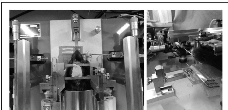
図1 両手間転移の実験例(右側面にレバーがある場合) 頭部を固定されたラットは側面にあるレバーを前に押し出すことによって報酬を得ることができる。レバーの反対側の前肢は赤色のプラスチック製のカバーによりレバーまで届かない。
