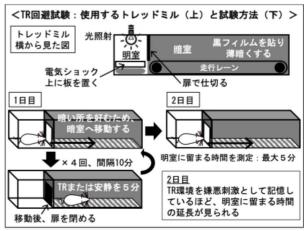
BALB/c マウスを、TR 経験群とTR 未経験群に分けた。TR 経験群の運動強度は、課題1でストレス反応の惹起が確認されたLTR とした。LTR を5分間4セット経験させた場合と経験させなかった(同時間・回数トレッドミル上で安静にさせた)場合で、24時間後にTR 環境へ再暴露した際の回避行動の変化を観察した。回避行動は、5分間観察し、TR 回避スペースに滞在した時間(TR 経験群>TR 未経験群と仮説)とTR 環境へ侵入した回数(TR 経験群<TR 未経験群と仮説)から評価した。
