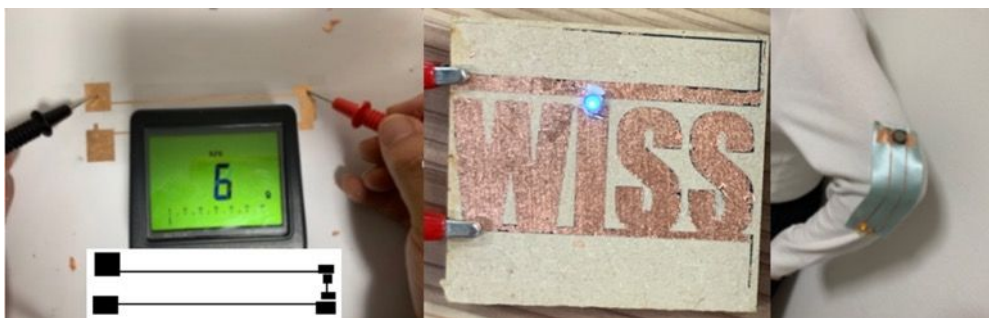
図 1 左：レーザプリンタを利用した紙の上の回路 中央：トナー転写用紙を利用した木材への実装 右：布を活用した回路例
