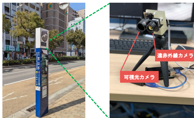
図 8. バス停に設置したカメラの構成
