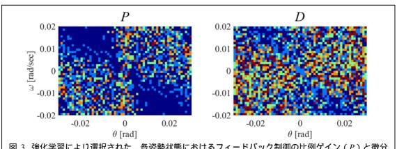
図 3. 強化学習により選択された, 各姿勢状態におけるフィードバック制御の比例ゲイン (P) と微分 ゲイン (D) の様子.
