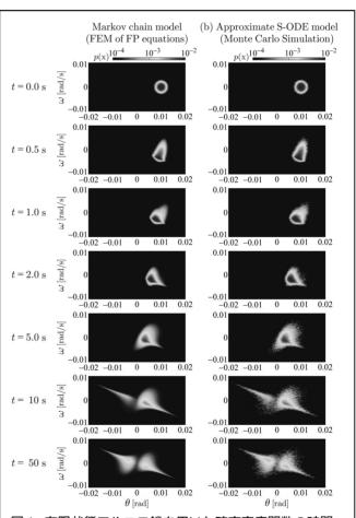
図 1. 有限状態マルコフ鎖を用いた確率密度関数の時間 変化の数値シミュレーション結果.
