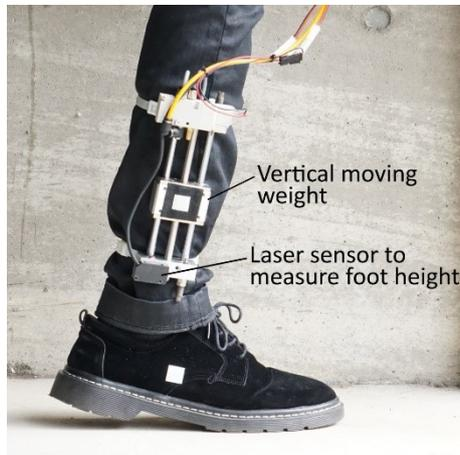
図9 人間のすねに付けたアシスト装置
