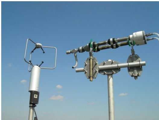
図3. 大気中NH 3 捕集用デニューダ・フィルターパックシステム(右側).
