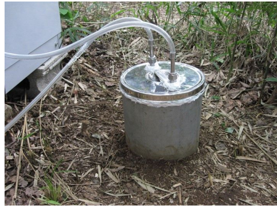
図2. (a)ラドン鉛直濃度分布測定システムと(b)土壌からのラドン散逸率測定チャンバー.
