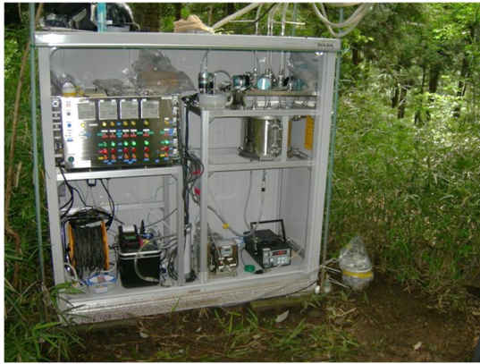
図2. (a)ラドン鉛直濃度分布測定システムと(b)土壌からのラドン散逸率測定チャンバー.
