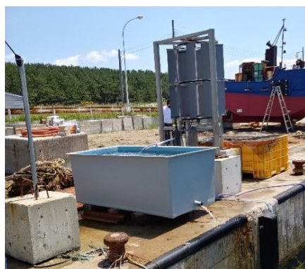
図 1 抗力型垂直軸風車を用いた直動式揚水ポンプシステム
