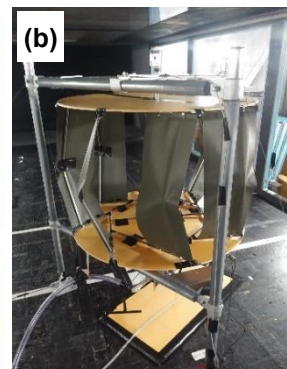
図 2 実験に用いた 8 枚翼垂直軸風車の基本形の断面図 (a), ならびに実験時の風車仕様の一例 (b).
