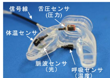
図1 著者らが製作したバイタルサインモニタリング用のダイバーマウスピース
