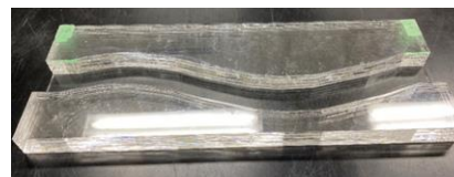
図5 試作した流動ファントムシステム
