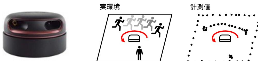
図 1 使用した LiDAR (RPLIDAR A2M8) および計測手法
