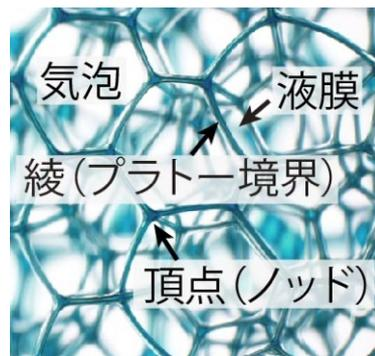
図3: 泡沫の内部構造. 気泡間を隔てている液膜が交わってできた綾（プラトー境界）のネットワークが形成されている。このプラトー境界のネットワークを通じて、重力下では泡沫の上部から下部に液体が排水される。
