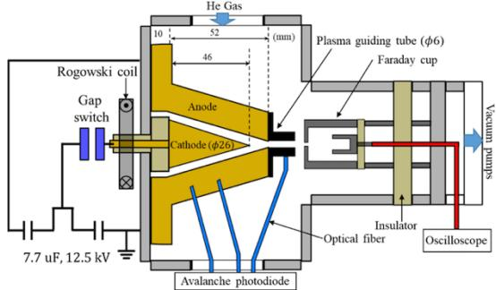
図1 構築したPF装置の概略
