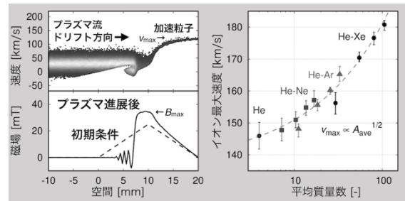
図 7 Hybrid PIC シミュレーションによる電磁パルス駆動プラズマ流と垂直磁場の相互作用の解析結果
