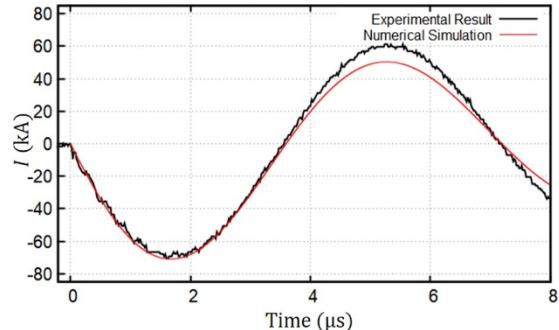
図3 放電電流波形
