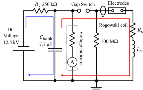
図2 PF装置の等価回路図
