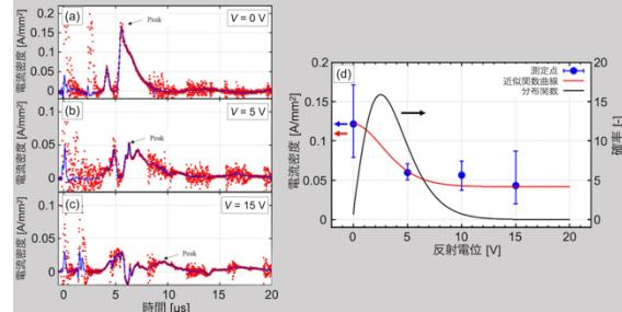
図 6 イオン電流波形および V-I 特性
