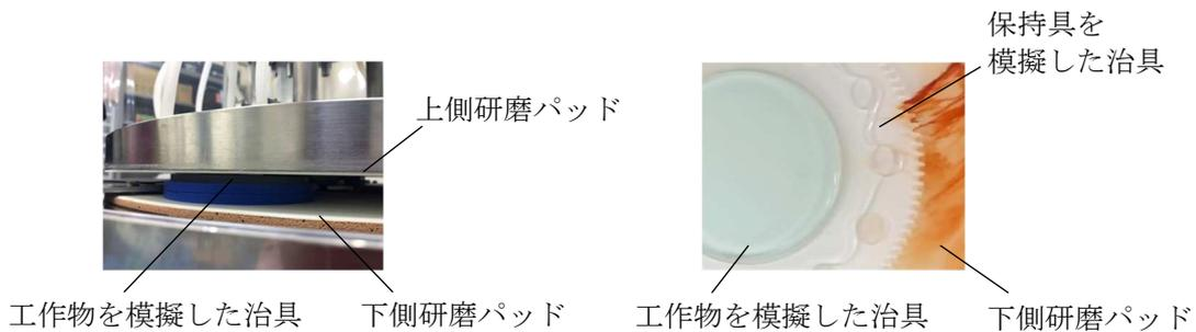
図2 工作物と研磨パッド間の摩擦状態の評価
