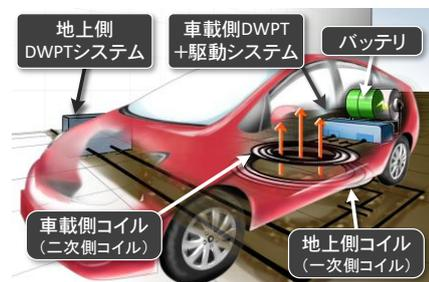
図1 EVへの非接触給電
