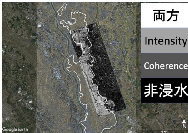
図 5 TSIC 法による浸水領域の検知結果
