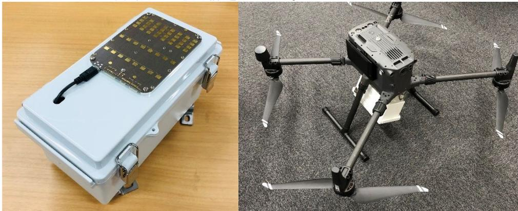
図 6 作成した車載レーダをもとにした観測装置（左）およびこれを搭載したドローン（右）
