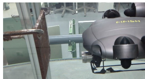
Fig. 7 ROV 搭載による測定の様子
