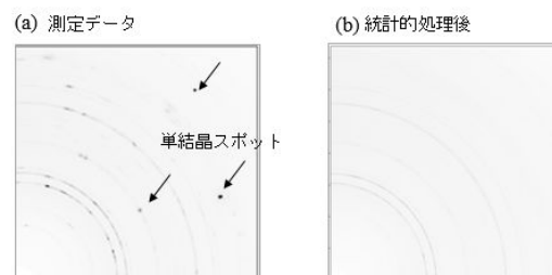
図6. (a,b)単結晶ダイヤモンドアンビルセル中の粉末試料を測定したXRDパターンに対して、(a)と同様のスキームを適用した結果。セルに起因した単結晶スポットや不均一なデバイリングが均一化されていることが分かる。
