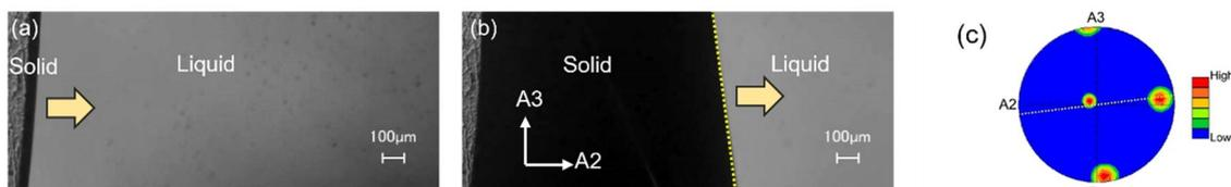
図 2: (a,b)固液界面に形成した Sb ファセット面の成長の様子および(c)観察範囲における  $1\bar{1}02$  極点図。
