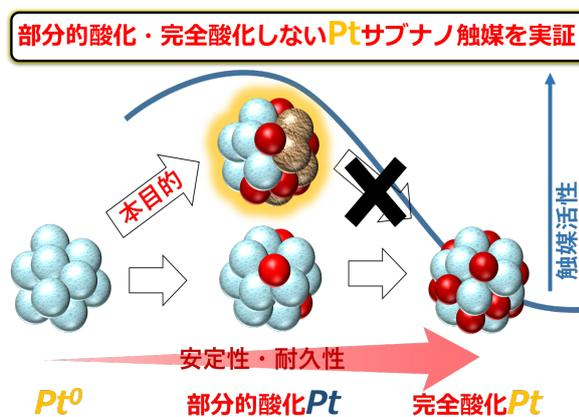
図2 部分的酸化 Pt 合金サブナノ粒子の特性
