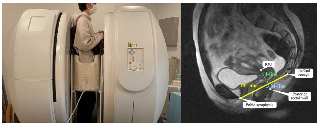
図 1: 縦型オープン MRI による骨盤底筋位置の計測
