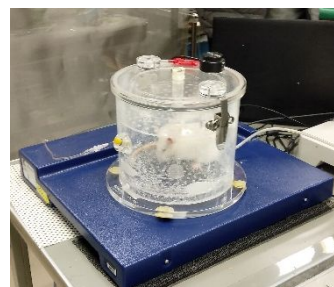
図 3 テレメータシステムの受信装置とプレチスモグラフィによる呼吸パラメータの測定
