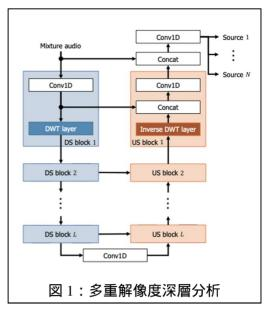
る技法を用いた.リフティングスキームでは,ウェーブレットを予測・更新作用素によって間接的に定義できる.これらの作用素を適切に変更することで,様々な有限長のウェーブレットを実現できる.これにより,様々なウェーブレット間での性能比較が容易にできるようになった.ウェーブレット間の性能比較実験により,既存のウェーブレット間では分離性能に大きな差がないことを確認し,実装が簡易で計算速度も速い Haar ウェーブレットを用いれば十分であることを実験的に確認した.また,実験的に長いタップ長のウェーブレットを用いると学習が数値的に不安的になることも確認した.この場合,ウェーブレットの周波数特性は特定周波数帯域におい
