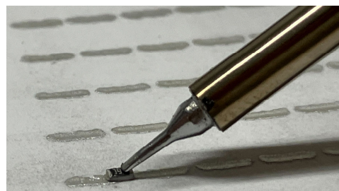
図3: 印刷した回路そのものを活用した部品実装手法
